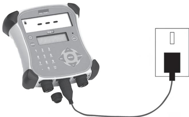
*Hinweis:* Wird die Stromversorgung des Terminals unterbrochen, zeigt das Batteriesymbol den aktuellen Ladezustand.
