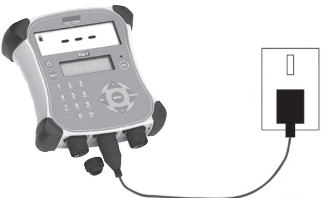
**注意：**当重量显示器与电源分离时，电池电量显示图标显示出电池已充电量。
