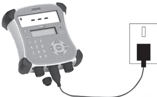
*Observação:* Quando o indicador da bateria for desconectado da fonte de alimentação, o indicador da bateria mostrará o nível de carga da bateria.
